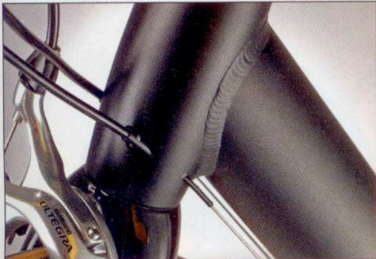
Typisch Roy Hinnen: Die Schaltzüge verschwinden im Steuerrohr.
