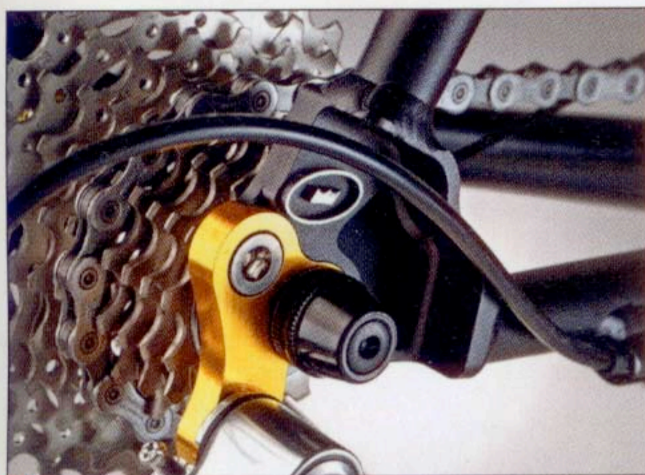
Golden Eye: das auswechselbare Schaltauge im Heck
